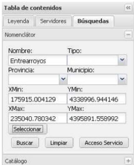
Si se presiona el botón Seleccionar, se puede obtener el bbox (ventana) sobre el que se va a buscar mediante el dibujo de un cuadro en el visualizador. Los campos que determina el bbox (XMin, YMin, XMax, YMax) también se pueden rellenar escribiendo directamente sobre ellos. No son campos obligatorios.
